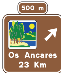
Preseñalización de salida en carretera convencional
